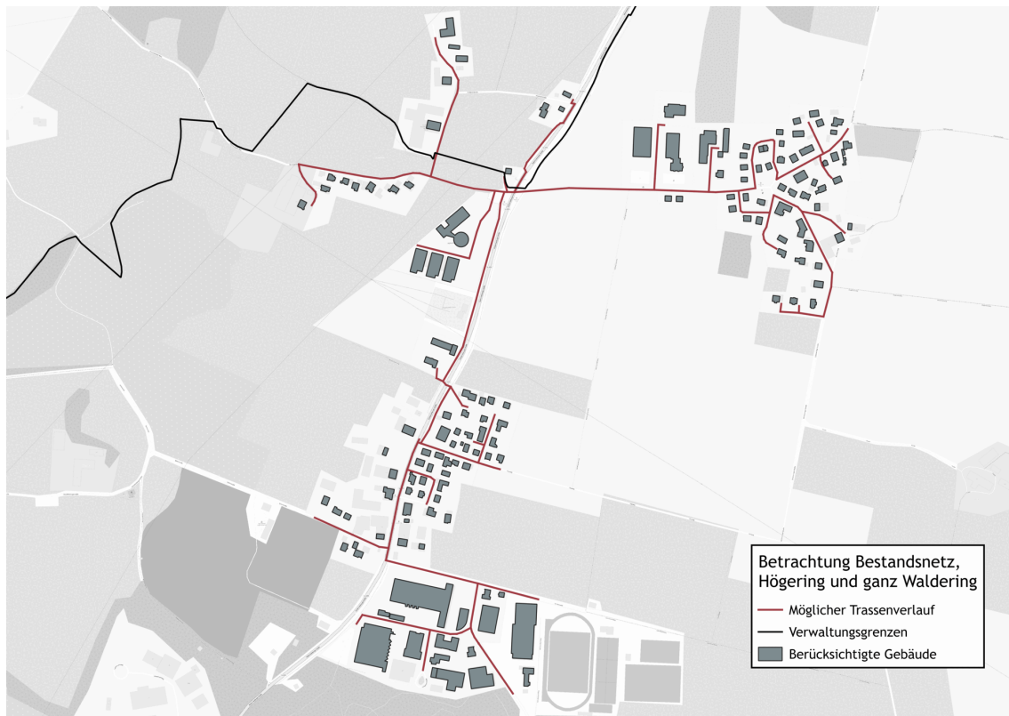
Abbildung 3.3: Detailbetrachtung Variante 1 (Bestandsnetz, Högering, ganz Waldering), möglicher Trassenverlauf eines Wärmenetzes, eigene Darstellung, Hintergrundkarte [1]
