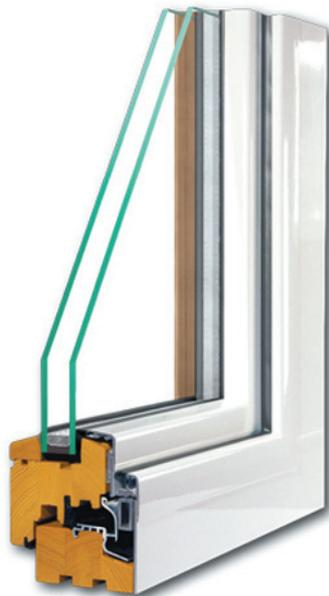
Eine Fensterrahmenverkleidung (Vorsatzschale) für Ihre alten Holzfenster kann die Wärmeverluste über den Rahmen verringern. Abschleifen und streichen können Sie sich dann in Zukunft sparen. Achten Sie darauf, wie Hinterlüftung und Regen- bzw. Schwitzwasserabführung gelöst sind! Diese Maßnahme lässt sich natürlich mit einem Scheibentausch kombinieren.
